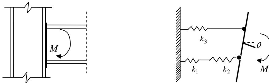
**Figure 2.11:** Modèle mécanique pour un assemblage de poutre-poteau soudé
