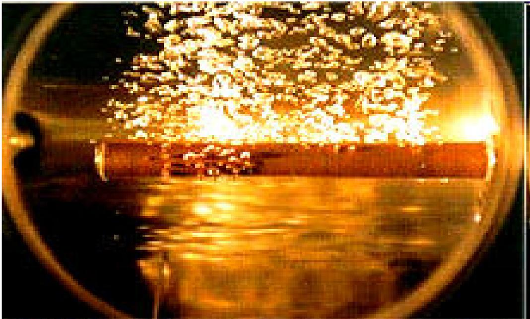
Figure1. Ebullition de l'eau sur un fil chauffant
