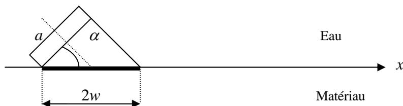
**Fig.III.6 : Diamètre de la surface éclairée par le champ acoustique suivant l'axe x.**
