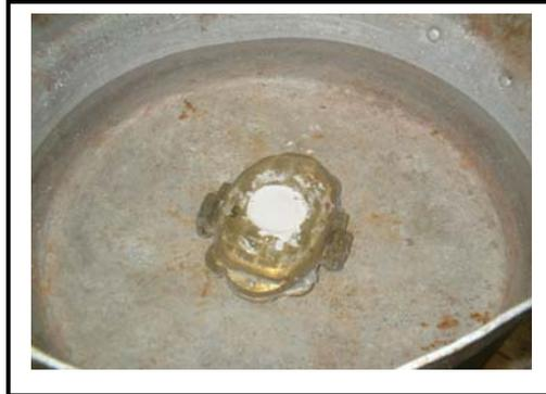
**Figure III. A. 4**: La polymérisation de PMMA (Le moufle dans un bain-marie).
