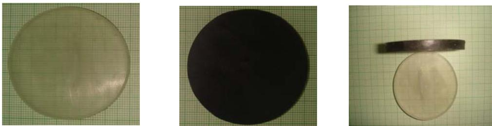
**Figure III. B. 9:** Echantillons utilisés: transparent concentration à 0%, noir concentration à 2%.
