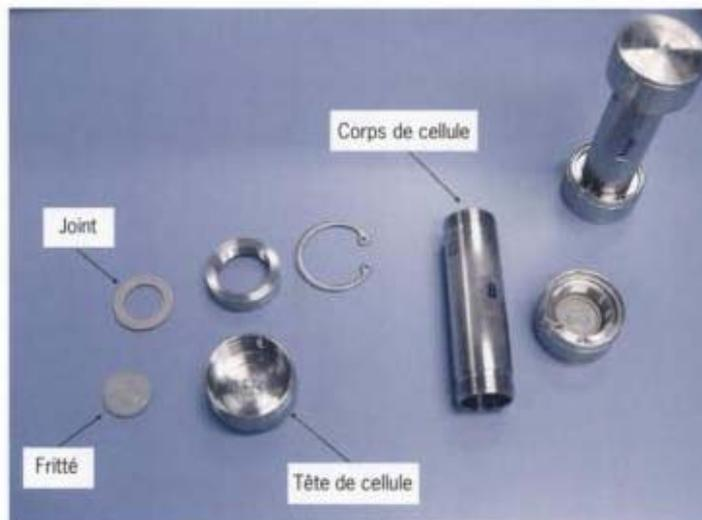
**Figure 23 :** Cellule d'extraction ASE
