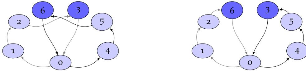
FIGURE 2.7 – Illustration d'un mouvement de l'opérateur *swap-intra*.
