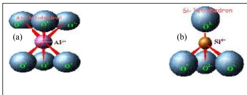
**Figure I. 1 :** Elément structuraux des argiles (a) : octaèdre ; (b) : tétraèdre.
