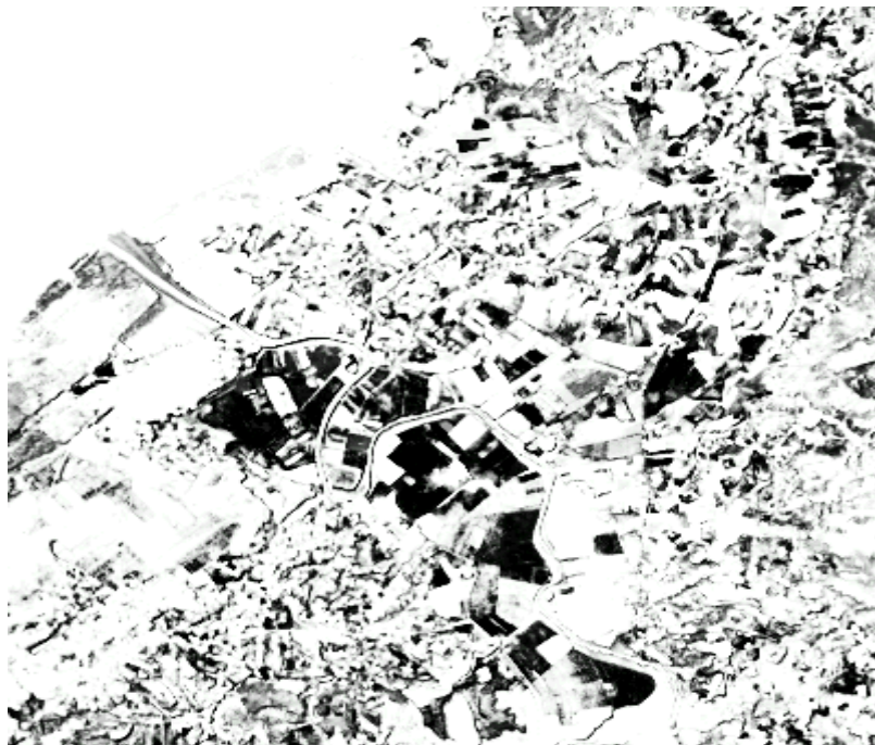
Figure 3.16. Degré d'appartenance dans la classe végétation \rightarrow sol nu obtenu par AC
