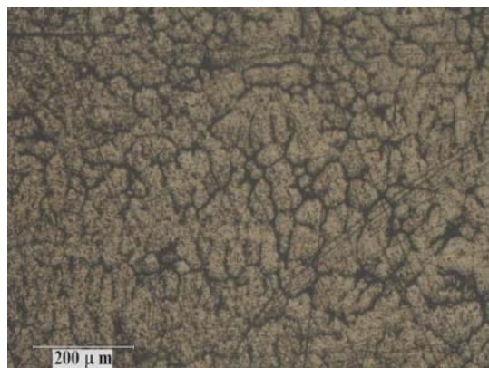
Figure.IV. 1 : Micrographie d'un échantillon après élaboration, subissant un refroidissement lent jusqu'à l'ambiante (structure dendritique)
