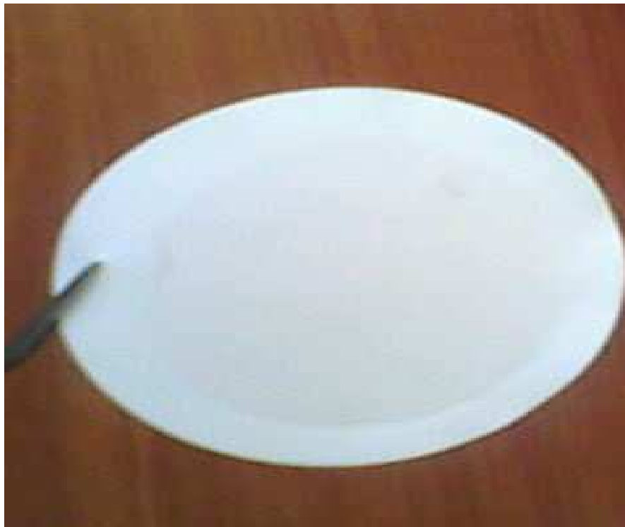
Figure - IIA.2-: Cible mince obtenue sous forme de dépôt sur filtre millipore après une étape de préconcentration chimique en utilisant le Na-DDTC comme complexant
