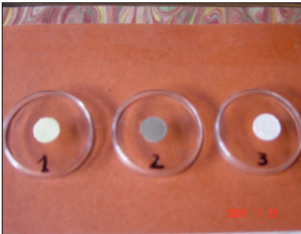
Figure -IIA.5- : Cibles obtenues sous formes de pastilles à partir des poudres d'eau de mer (1et3) et de standard GSN (2) compactées après lyophilisation
