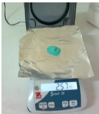
Figures II.2: La pesée des poudres métalliques à l'aide d'une balance de modèle OHAUS (scout-se)
