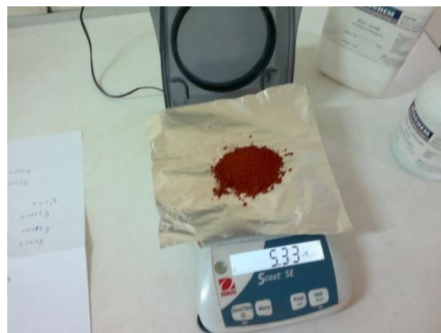
Figures II.2: La pesée des poudres métalliques à l'aide d'une balance de modèle OHAUS (scout-se)
