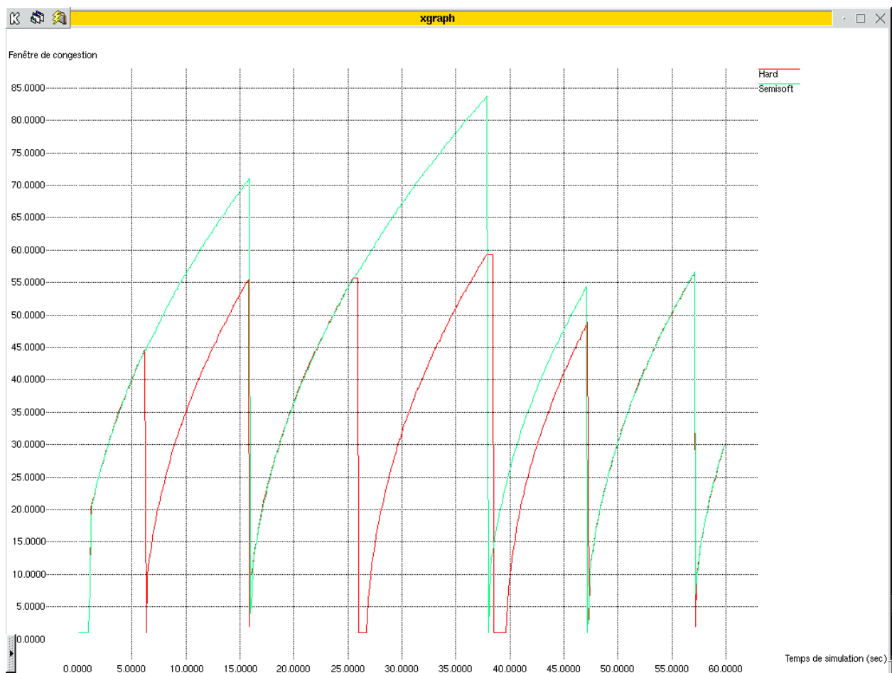
Figure 6.4 : Comportement de la fenêtre de congestion pour les deux schémas de handoff de Cellular IP
