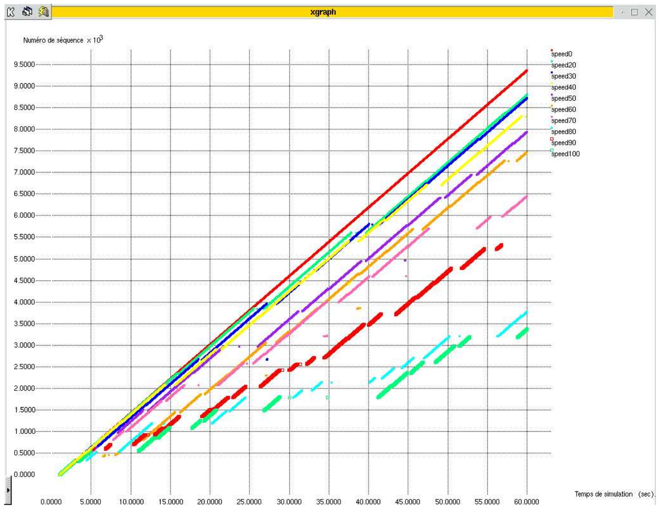
Figure 6.5 : Numéros de séquence sous le hard handoff pour différentes vitesses du MH
