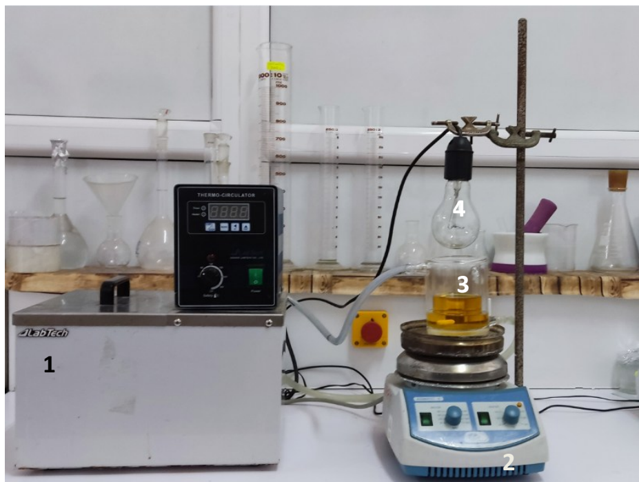
Figure II.9 : Dispositif expérimental utilisé. (1) bain marie (2) agitateur magnétique (3) réacteur a double paroi et (4) lampe.
