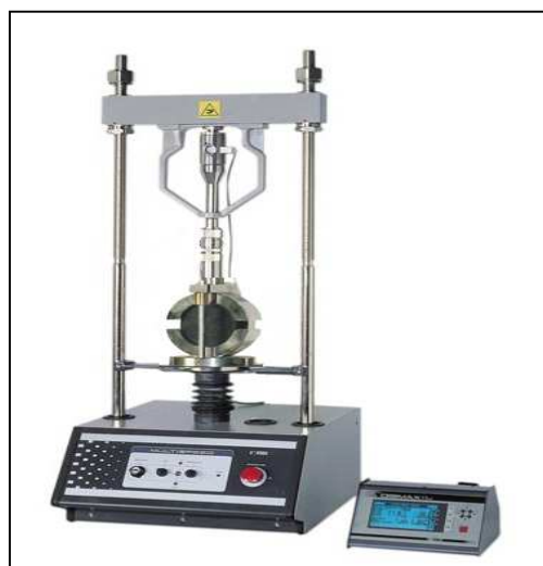
Fig 5.4 : Presse d'écrasement avec un enregistreur.
