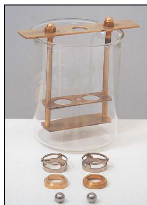
Fig 4.8 : matériel pour essai billes et anneaux.
