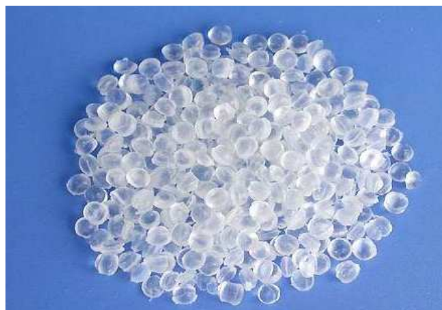
Fig 3.4 : Les granulats de l'EVA.
