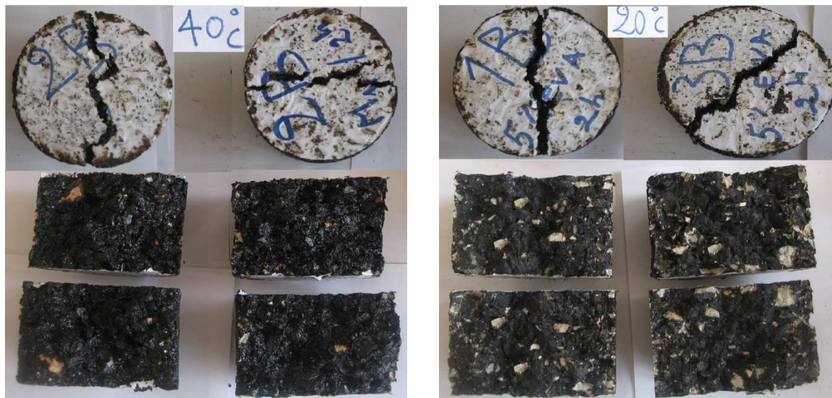
Fig 5.26 : Plan de rupture de quelques éprouvettes après la traction indirecte.
