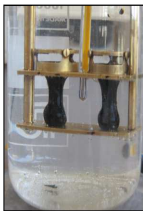
Fig 4.8 : matériel pour essai billes et anneaux.
