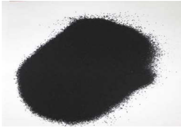
Fig 3.2 : Le NBR sous forme de poudrette.
