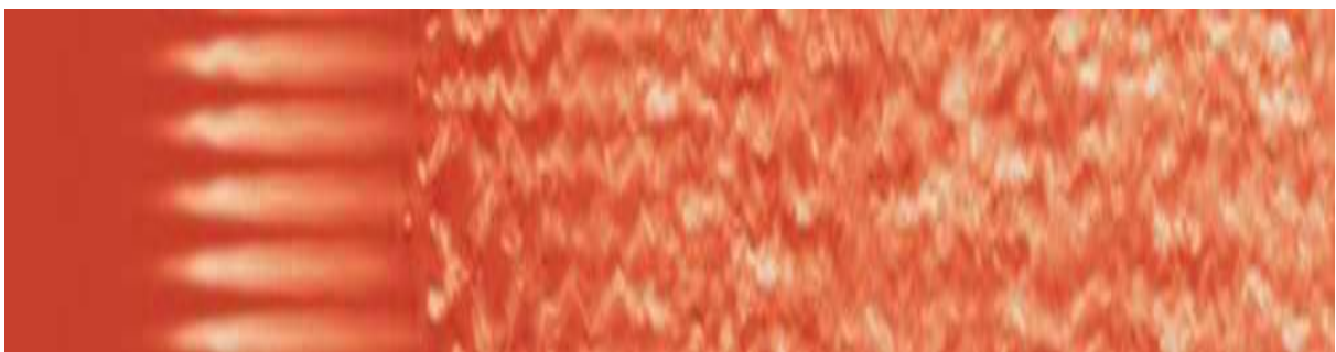
Figure. 3 .5.a : Visualisation de l'instabilité sinueuse des streaks et de la déstabilisation de la couche limite laminaire.
