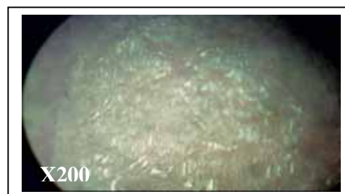
Photo 26 : Surface du zinc dans le couple zinc (1) -fer pur
