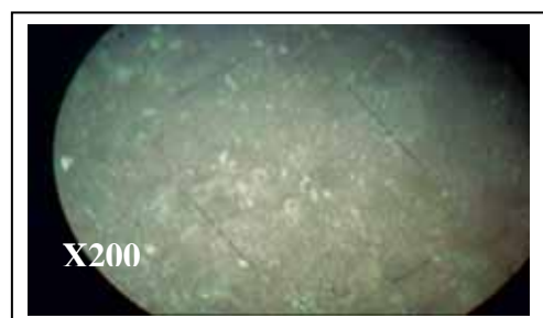
Photo 34 : Surface du zinc dans le couple Zinc (6) -fer pur
