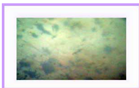
Photo 3 : Fer pur dans NaCl3% après polarisation en milieu désaéré
