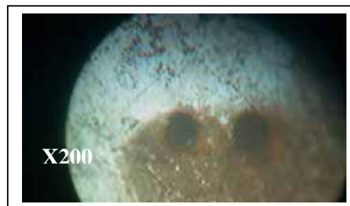
Photo 16 : Acier dans HNO 3 10 -4 M après un temps d'immersion.
