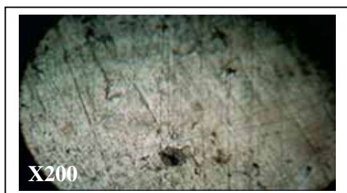
Photo 25: Surface du fer pur dans le couple zinc (1) -fer pur
