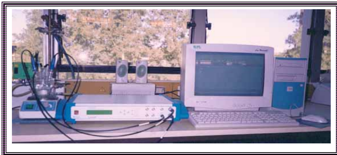
Figure 4 : vue d'ensemble de la chaîne électrochimique de marque Voltalab Radiometer Analytical.
