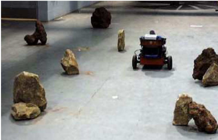
Figure 3.1 Robot mobile, équipé d'un télémètre laser, percevant un ensemble de balises (pierres) [Mon 02]
