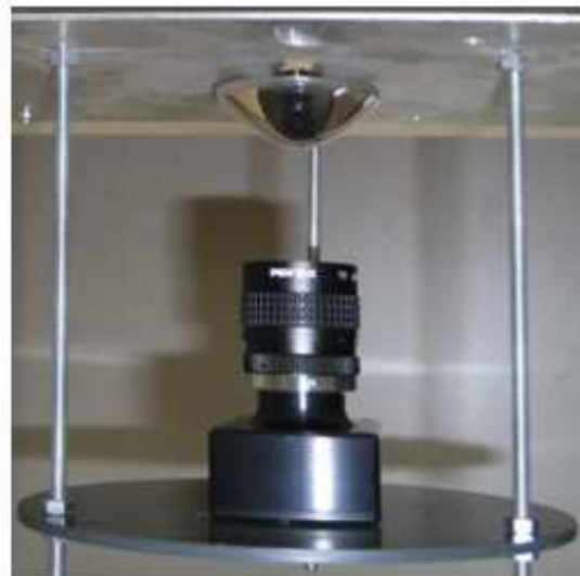
Figure 3.9 Principe des caméras panoramiques.
