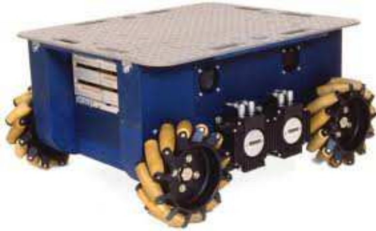
Figure 1.14 Robot mobile Uranus: un robot omnidirectionnel à quatre roues suédoise.
