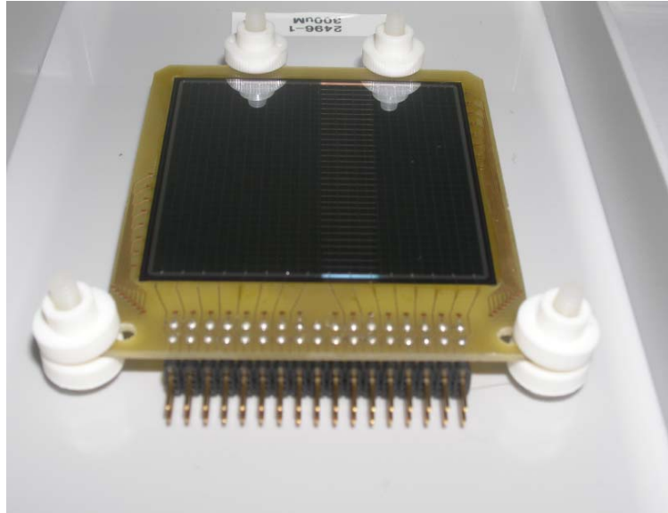
Figure II.6: Photographie représentant un détecteur Silicium double faces à 16 pistes sur chaque face.
