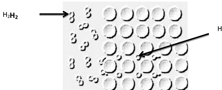
Figure II.4 : Schéma du principe de stockage de l'hydrogène dans un matériau hydrure.
