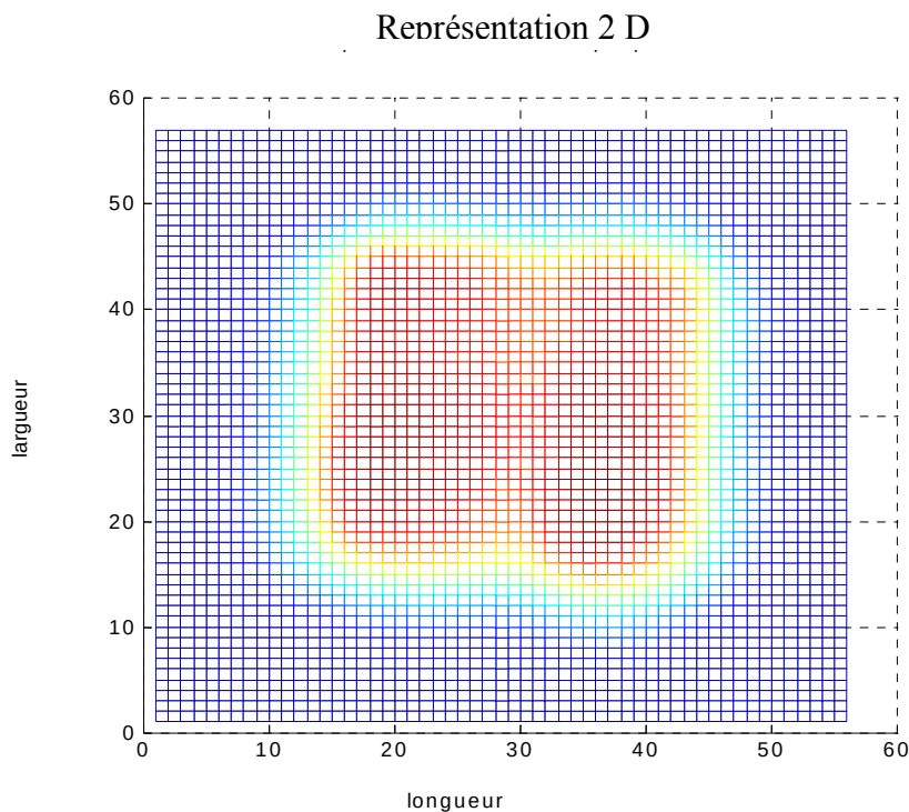
Figure. 4.4 : image ultrasonore dans le cas de la plaque a) Représentation 3D b) Représentation 2D.
