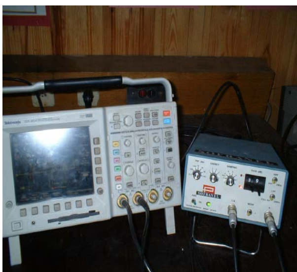
Emetteur-Récepteur à ultrasons et Oscilloscope pour la visualisation des résultats.
