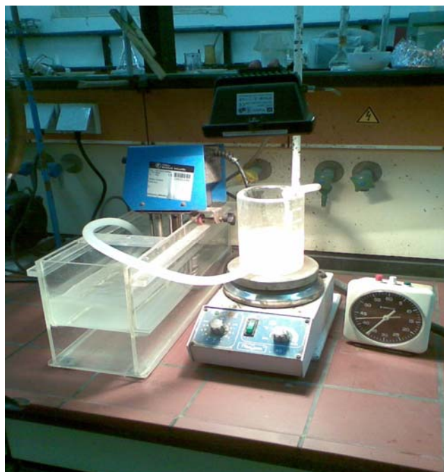
Figure II-1. : Dispositif expérimental utilisé pour l'évaluation de la photoactivité
