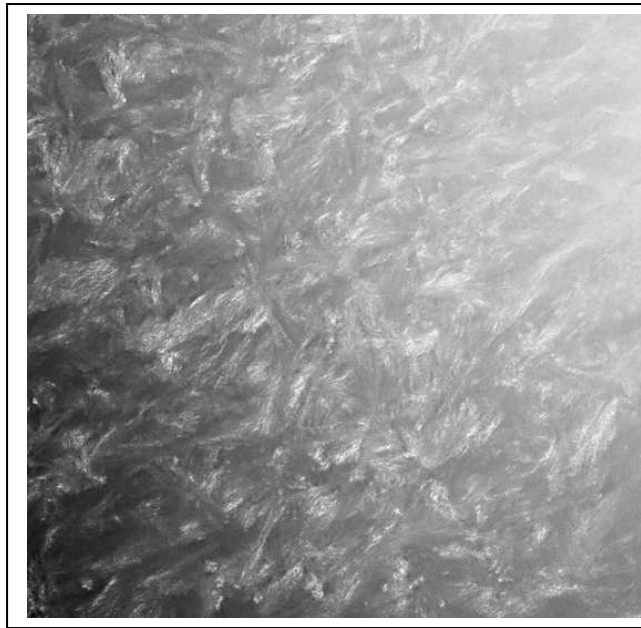
Figure III. 2 : Cristallites dans du polyéther-éther cétone Microscopie électronique, A. Boudet [3]
