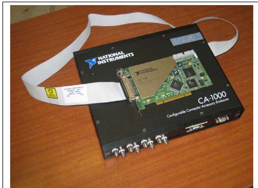
Figure-21- Carte d'acquisition PCI-6034E de 16 bits avec accessoire et câble de connexion fabriquées par National Instruments
