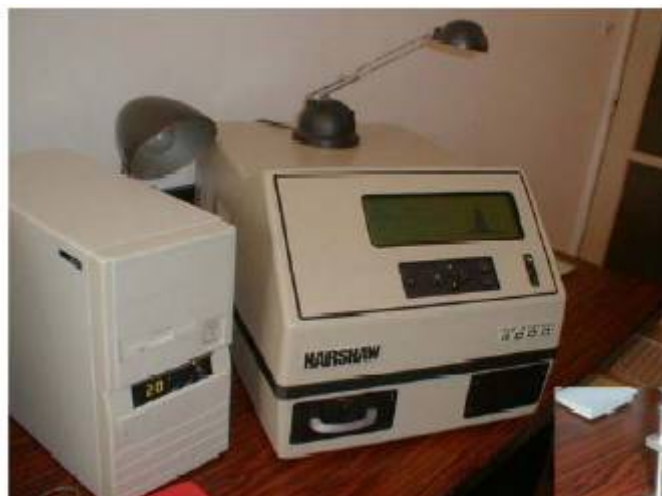
Figure III.19 : Système de lecture Harshaw 4000 utilisé pour la lecture TLD.
