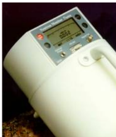
Figure III.13 : Moniteur de neutrons Studsvik modèle 2222 A [Neutron monitor, 2007].
