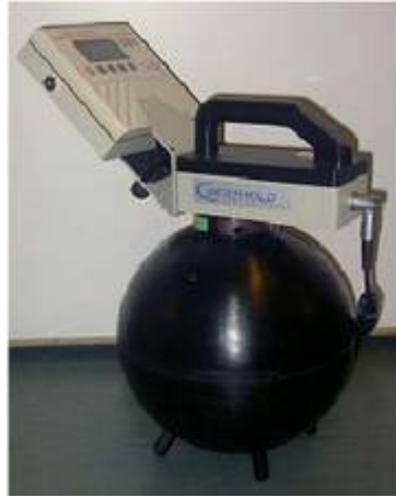
Figure III.15 : Compteur à neutrons à ^3\text{He} Berthold modèle LB 6411 [Berthold, 2006].
