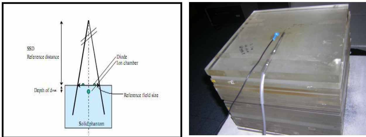
Figure III-26: schéma représentant la position de la diode par rapport à la chambre d’ionisation au cours des mesures des facteurs correctifs
