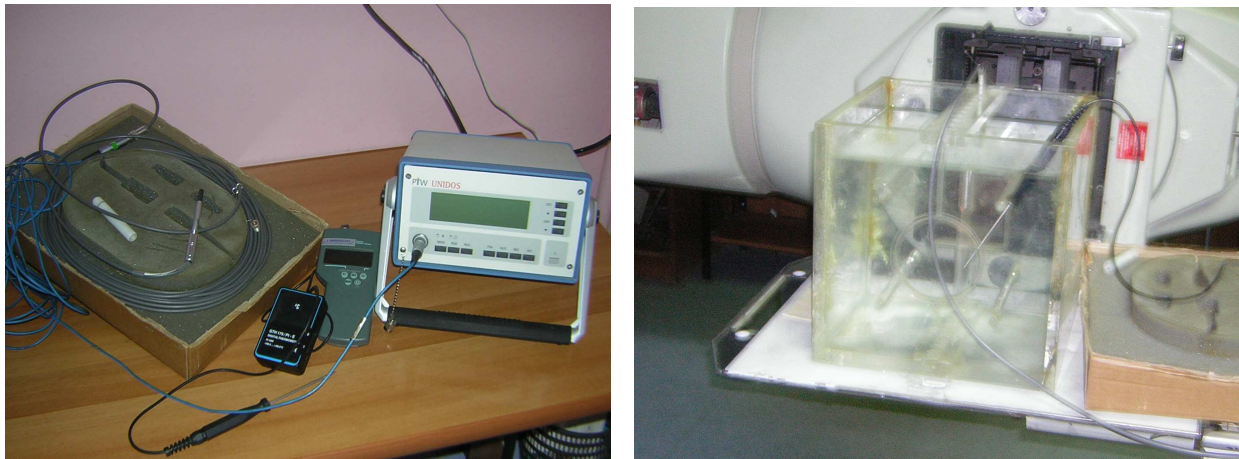
Figure III-25 : Chambre d'ionisation, électromètre, baromètre thermomètre et fantôme d'eau utilisés dans la mesure du débit de dose de référence.
