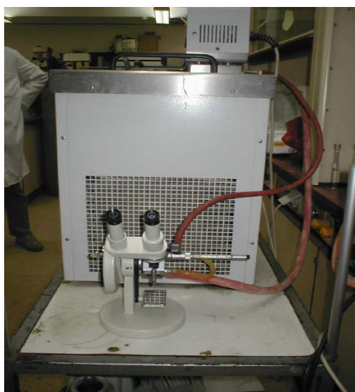
Fig.V.5. Réfractomètre et système de refroidissement thermostaté
