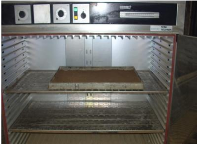
Figure III.1 : Séchage du sol agrégé à l'étuve.
