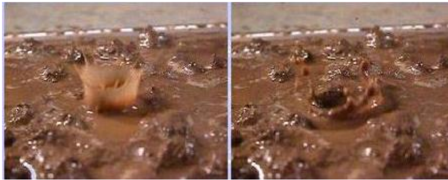
Figure I.1 : Rejaillissement des particules sous l'impact des gouttes de pluie (Leguédois, 2003).
