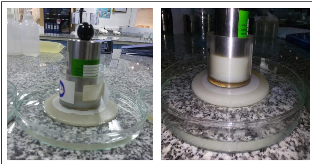
Figure II- 4 : Test d'absorption sous charge AUL d'un matériau superabsorbant.
