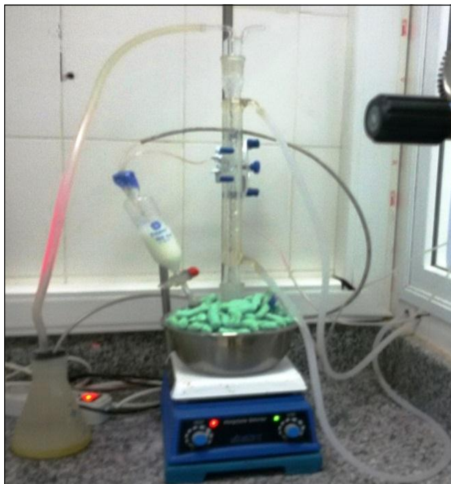
Figure II- 1 : Montage de polymérisation adopté pour la synthèse des hydrogels.
