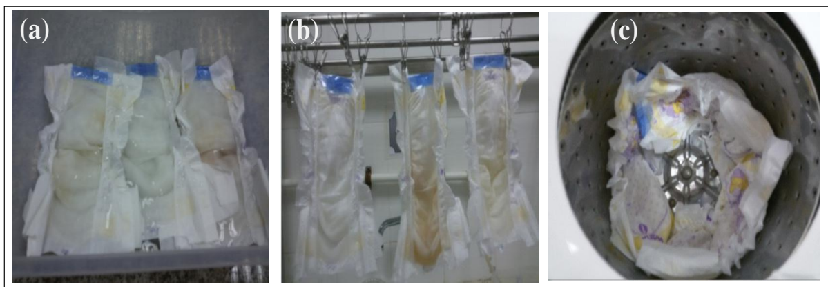
Figure II- 7 : Tests de capacités d'absorption libre (a,b) et de rétention (c) appliqués dans les couches pour bébés.
