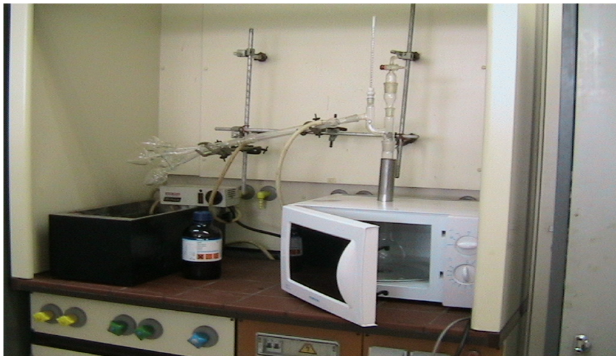
Photo 3: Four à micro-ondes domestique modifié S.W.402.
