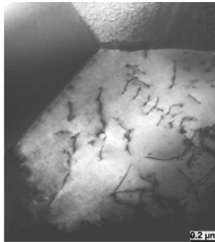
Figure II.4 : Micrographie MET d'un empilement de dislocations dans une solution solide sursaturée Pb 0.08 Ca 2 Sn (% en poids) déformée par laminage (75% réduction d'épaisseur) [4].
