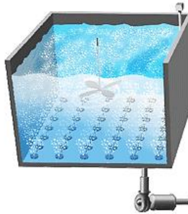
Figure 1.12 : Aérateur associant des diffuseurs fines bulles à membranes microperforées et un agitateur lent à grandes pales
