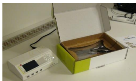
Figure 2.12. Sonde à oxygène et multimètre utilisés pour la détermination du coefficient volumique de transfert k_La
