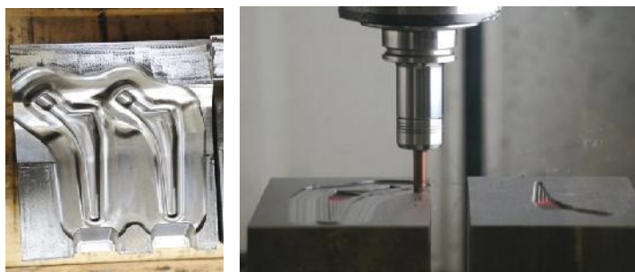
Figure I-2. Etape d'usinage d'une gravure pour moulage
