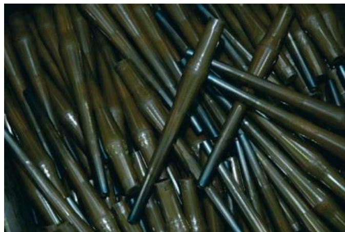
Figure I-5. Forme des lopins après déformation à chaud
