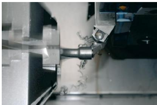
Figure I-13. Etape de l'usinage par enlèvement de matière
