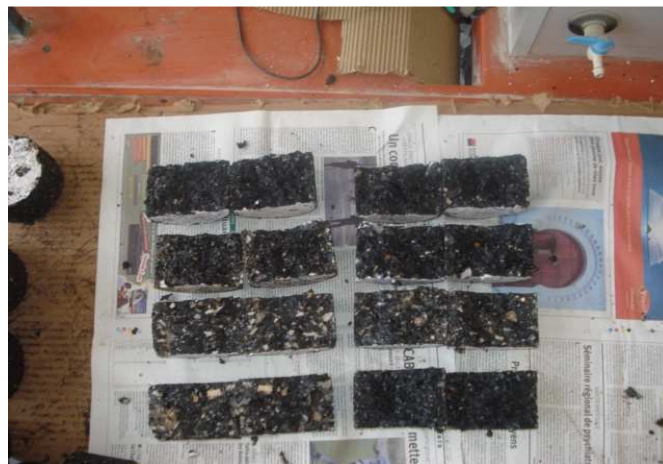
Figure 3.25. État des éprouvettes après l'essai
