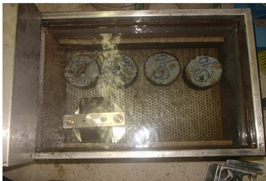
Figure 3.11 : Les éprouvettes et la mâchoire immergées dans le bain
