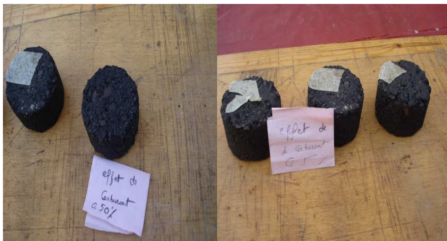
Figure 3.28. Eprouvettes (0.5%) après immersion dans le carburant
