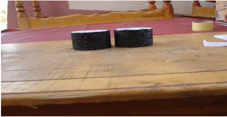
Figure 3.26. Eprouvettes avant immersion dans le carburant
