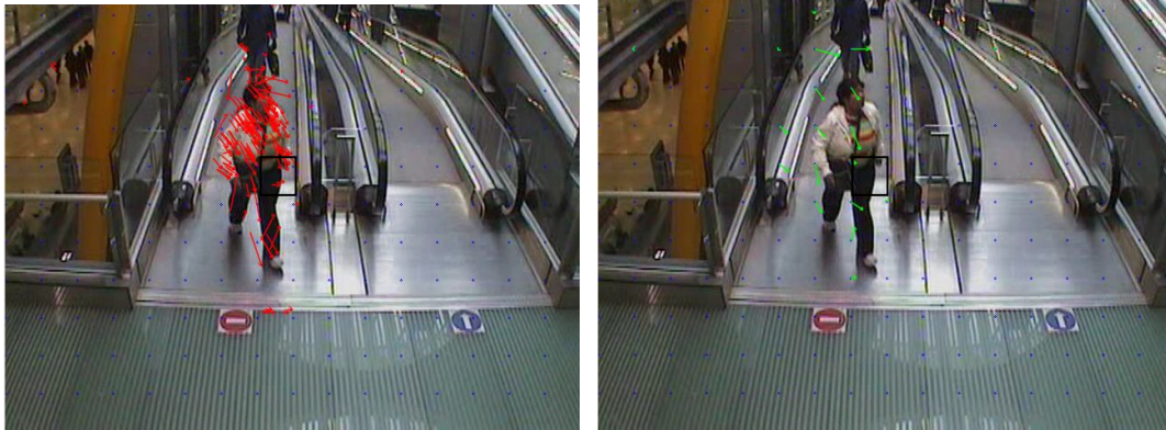
Figure 2.7 : A gauche : les vecteurs de mouvement pour une image. A droite : les vecteurs moyens calculés pour la même image.
