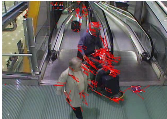
Figure2.4 : Exemple des vecteurs de mouvement d'une image
