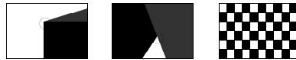
Figure1.4 : Différents types des points d'intérêts : coins, jonction en T et point de forte variation de texture
