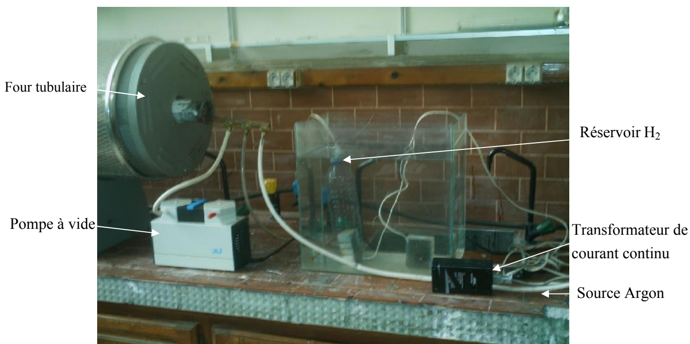
Figure II.2 : Dispositif expérimental de fragilisation.
