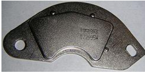
Figure I.7: Aimant de Néodyme issu d'un disque dur.
