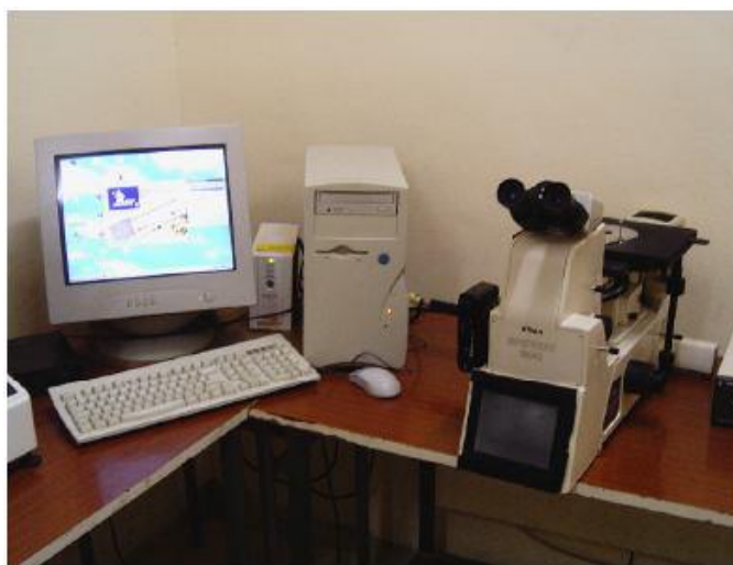
Figure II.13 : Ensemble microscope métallographique [photo LSGM].
