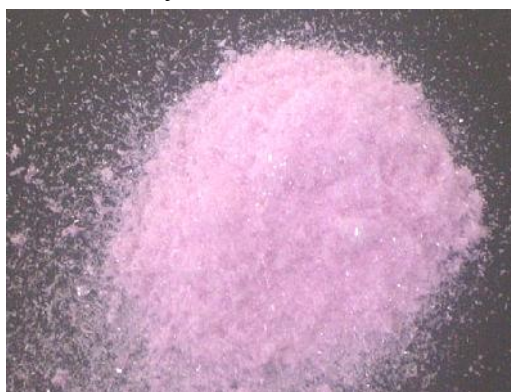
Figure.III.7 : Oxalate de néodyme ( \text{Nd}_2(\text{C}_2\text{O}_4)_3 \cdot 10\text{H}_2\text{O} ).
