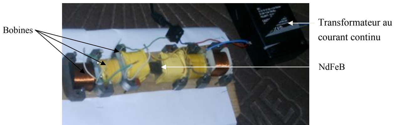
Figure II.12 : Montage d'aimantation de l'alliage NdFeB.
