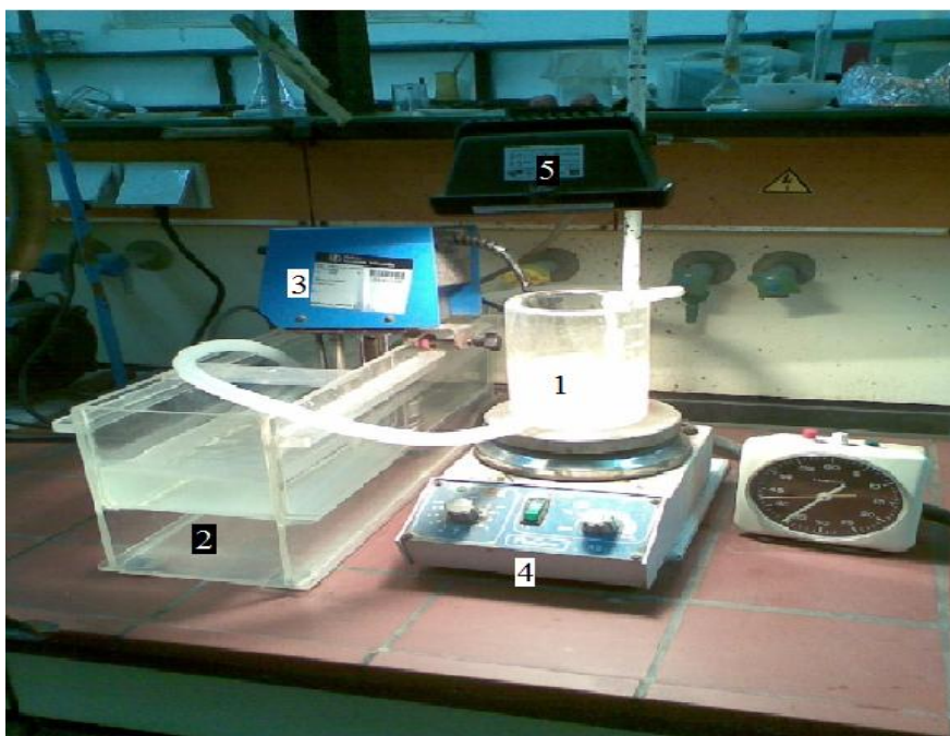
Figure II-5 Dispositif expérimental pour la photo-dégradation
