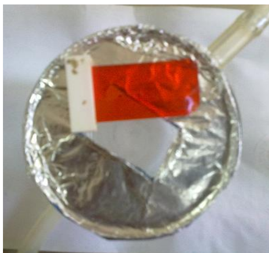
Figure II-6 : Dispositif pour la photo-catalyse sous lumière filtrée.
