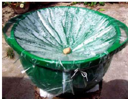
Fig.1.2 : Distillateur solaire statique réel
