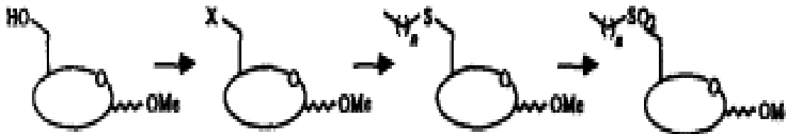
Schéma 14: Synthèse des tensioactifs glycosidiques par l'intermédiaire de sucres halogénés. Thioethers et sulfones dérivés de l' \alpha -d-glucoside et l' \alpha -d-mannoside de méthyle
