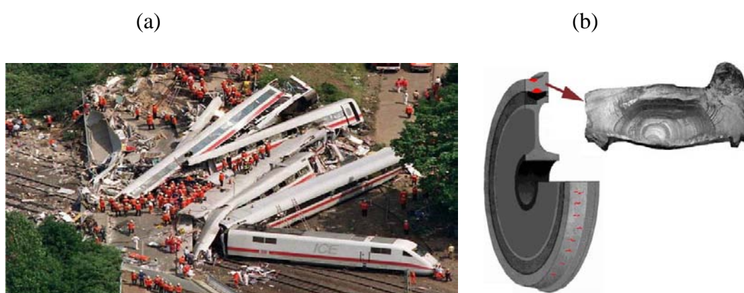
Figure 1.11: (a) Accident du train allemand ICE à Eschede (Allemagne) en juin 1998. (b) Rupture d'une roue fissurée Richard et al [48]
