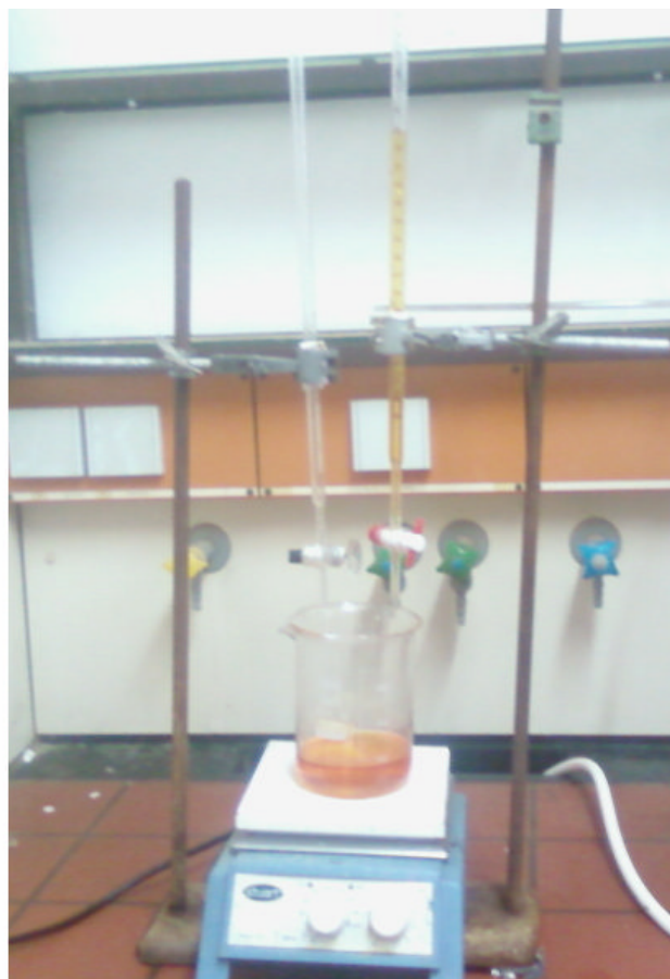
Figure-1: Montage de synthèse des solides Mg-M-HDL (M = Fe, Cr, Al) .
