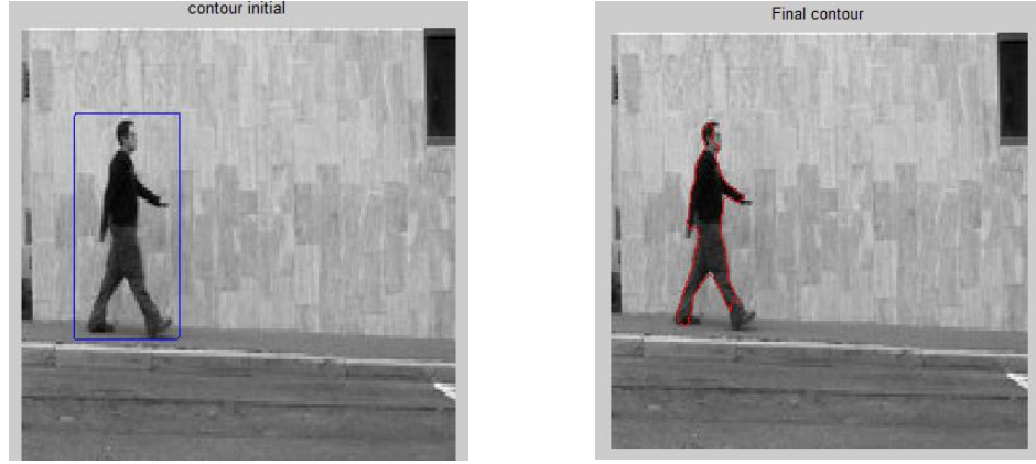
Fig.III.8 : Image réelle, Param. de segmentation : v=0.1 ; dt=0.1 ; \varepsilon_k=0.1 ; \lambda = 25 ; \varepsilon_{cag}=1.5 ; reinit. Chaque 10 itérations ; nb. Itér, 1000.
