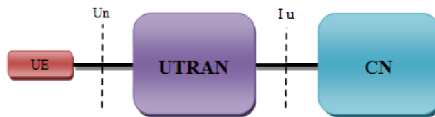
FIGURE 1.10 – Architecture du réseau UMTS.
