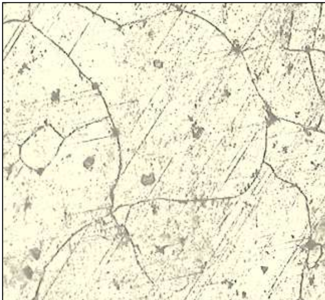
Micrographie 3 pour Al-20% Zn -1%Mg traité à 70°C pour 70h ; G=50.
