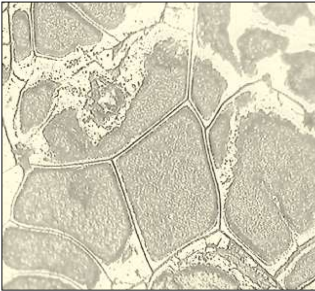
Micrographie1 pour Al-20% Zn -1%Mg traité à 200°C pour 0.5h ; G=100.
