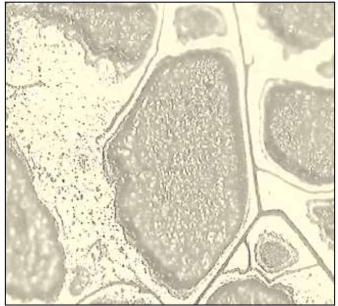
Micrographie 2 pour Al-20% Zn -1%Mg traité à 200°C pour 0.5h ; G=200.
