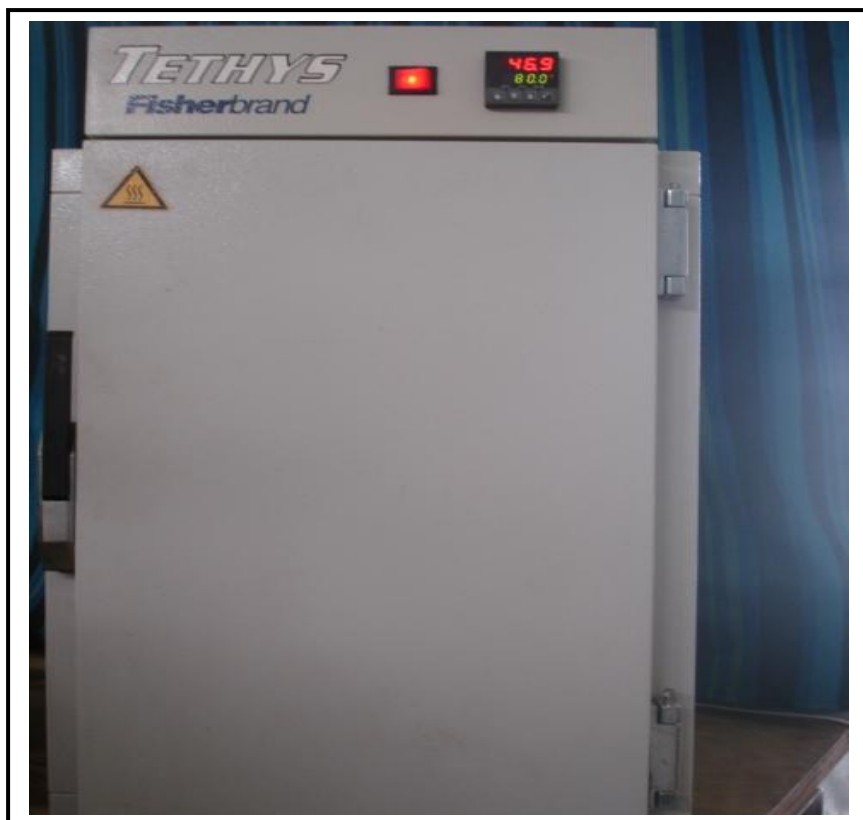
Fig. III.2 : Etuve des traitements de revenu.
