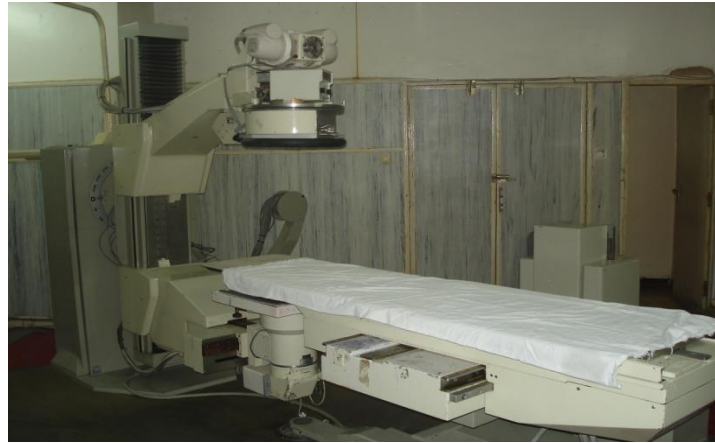
Figure II. 7: Appareil de simulation disponible au niveau du service de radiothérapie du CPMC, c'est un Kermath model T3-T-101.
