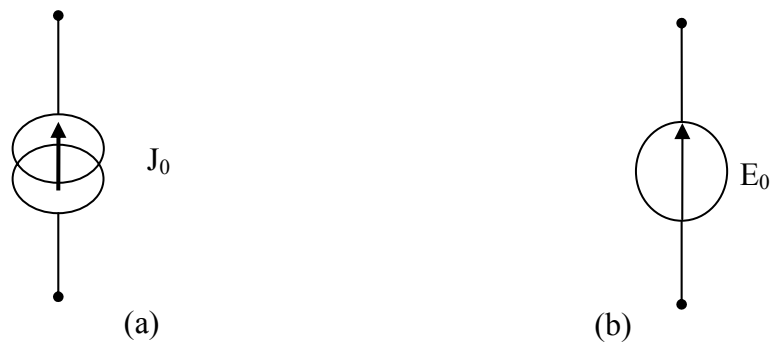
Figure 2.6 Représentation des différentes sources ; (a) Source de courant électrique. (b) Source de champ électrique
