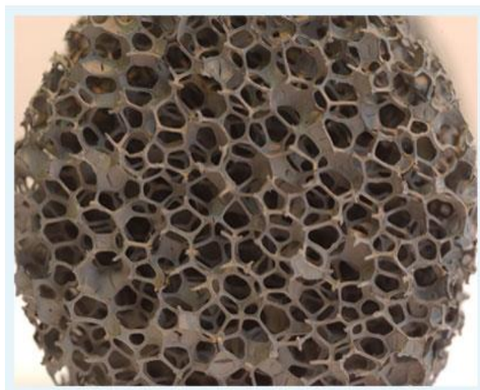
Figure I.7 : Catalyseur mousse utilisé au niveau du pot d'échappement des automobiles [3]
