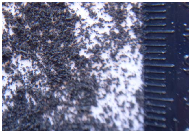
Fig.2.3. La poudrette de caoutchouc NR sous une loupe[Mag 2009].
