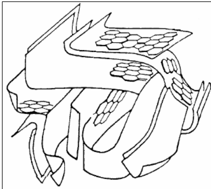
Figure 2 : Représentation schématique de la microstructure du charbon actif [6].
