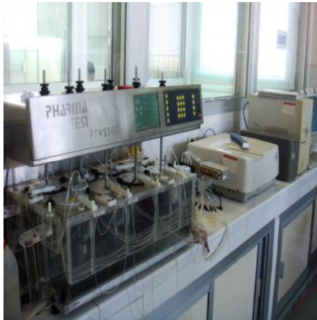
Dissolutest couplé avec un détecteur UV-vis
