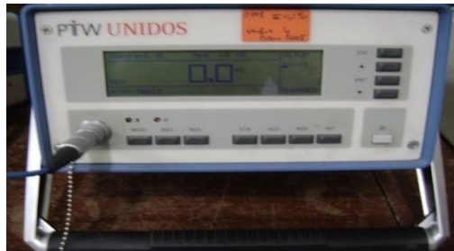
Figure II.9. Electromètre utilisé pour l'étalonnage et la dosimétrie
